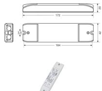
Scheda tecnica Osram LED driver Optotronica CV 1-10V | Dimmerabile
