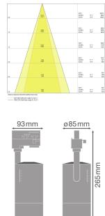
**Scheda tecnica Ledvance Luce a Binario LED D85 Nero 25W 1500lm 15-55D - 830 Luce Calda | Mechanical Zoom - Dimmerabile**
