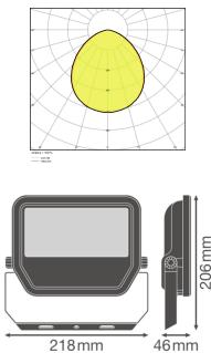
**Scheda tecnica Ledvance Proiettore LED GEN 3 Bianca 50W 6000lm 100D - 840 Bianco Freddo | IP65 - Simmetrico - Sostitutiva 100W**
