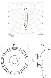
Scheda tecnica Ledvance LED spot G53 AR111 11.7W 450lm 40D - 930 Luce Calda | Miglior resa cromatica - Dimmerabile - Sostitua 50W
