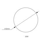
Scheda tecnica Noxion Bulkhead LED Corido Bianca 22W 2075lm - 840 Bianco Freddo | 410mm - IP44
